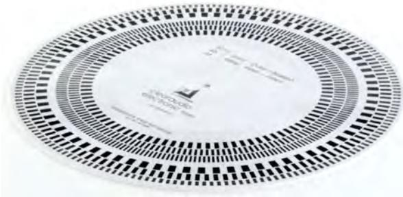
Afin de régler précisément la vitesse, veuillez sélectionner la face 50 / 60 Hz, ou l'autre face si vous commencez par un test avec la source de lumière.
